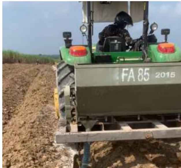
Gambar 2. Pemupukan dasar tanaman tebu menggunakan fertilizer applicator
