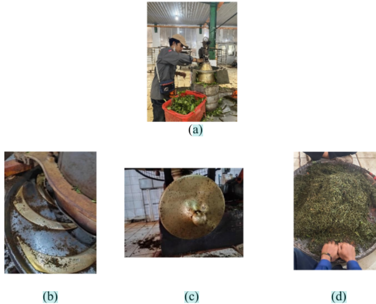
Gambar 4. Proses penggulungan: (a) Proses penggulungan, (b) Cones , (c) Batten , (d) Penggulungan manual (Sumber: Dokumentasi Pribadi, 2024)
