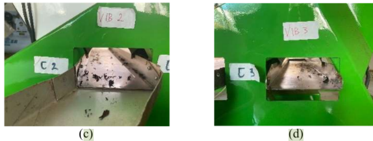
Gambar 7. Proses Sortasi: (a) Proses pemasukan teh kering kedalam mesin color sorter , (b) Corong 1, (c) Corong 2, (d) Corong 3 (Sumber: Dokumentasi Pribadi, 2024)
