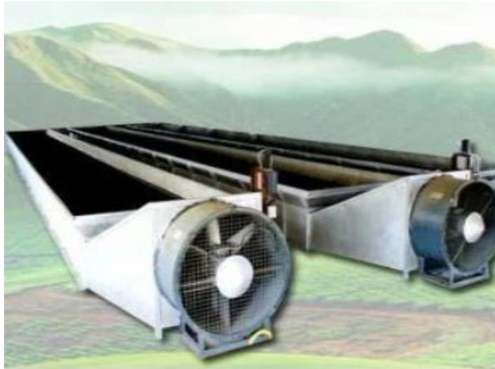
Gambar 1. Alat Mesin Pelayu Teh (*Withering Trough*)
