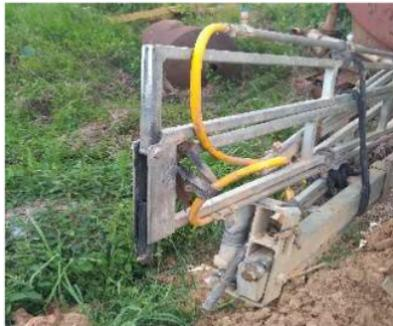
Gambar 39. Selang dan pipa *boom sprayer*
