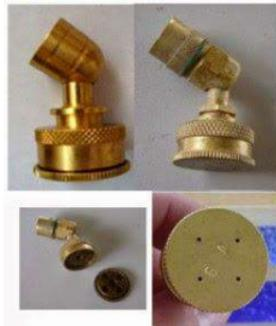
Gambar 18. *Nozzle* lubang empat
