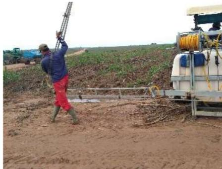
Gambar 35. Proses membentangkan sayap *boom sprayer*
