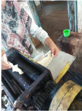
Gambar 9. Penggilingan lateks untuk mengurangi kadar air pada lateks
