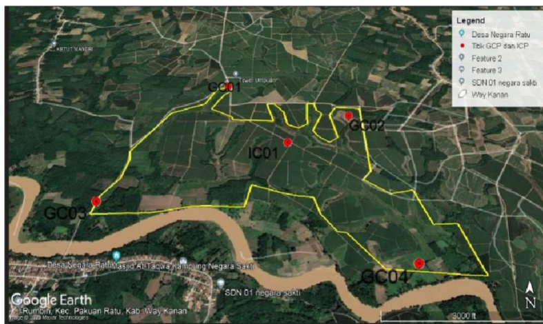
Gambar 4. 1 Penempatan titik kontrol GCP dan ICP
