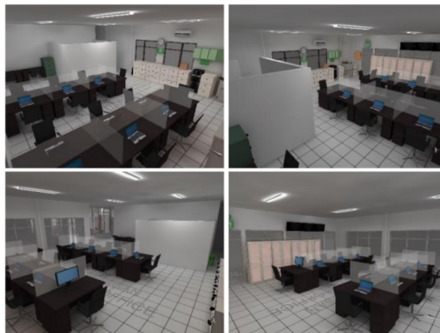
Gambar 26. Visualisasi 3D Simulasi Pencahayaan Eksisting Ruang Office (Sumber: Hasil DIALux evo 10.1, 2022)
