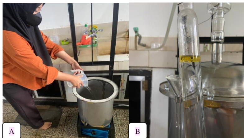
Gambar 6. Pembuatan minyak serai wangi dengan metode destilasi. (A) Proses pengisian air pada tabung destilasi. (B) Minyak atsiri C. nardus yang keluar dari alat destilasi. (Sumber: dokumentasi pribadi)
