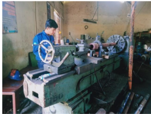
Gambar 32. Proses pembuatan as mesin press menggunakan mesin bubut
