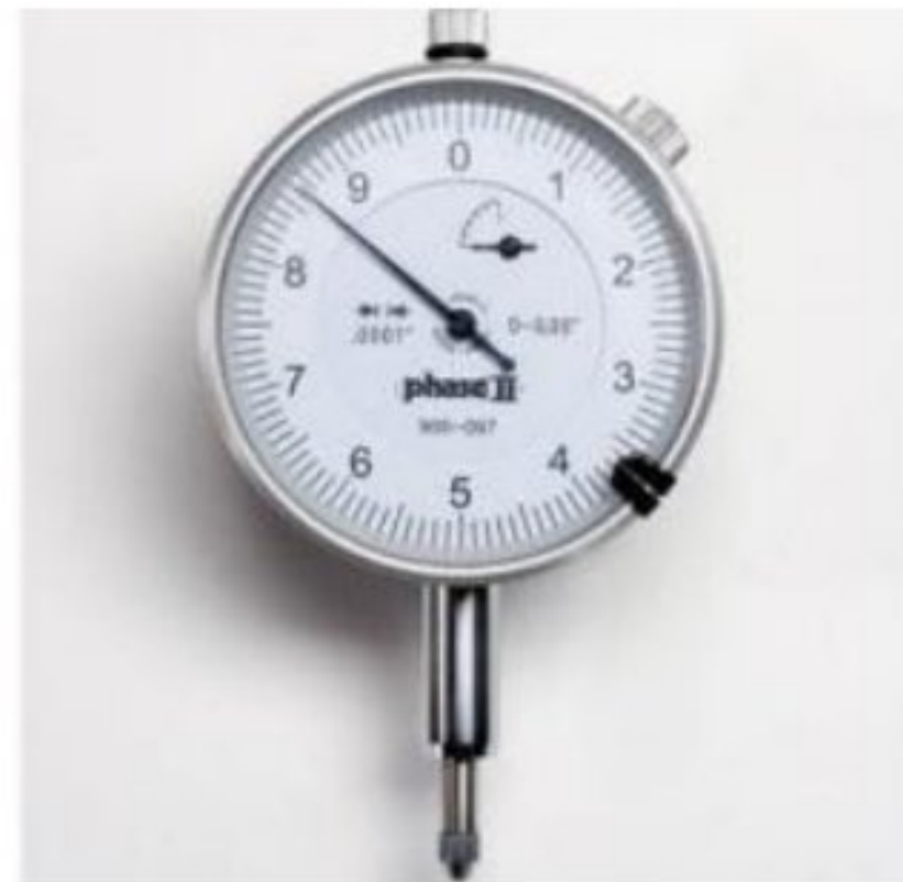
Gambar 25. Dial indicator atau dial gauge (Susanto, 2019)
