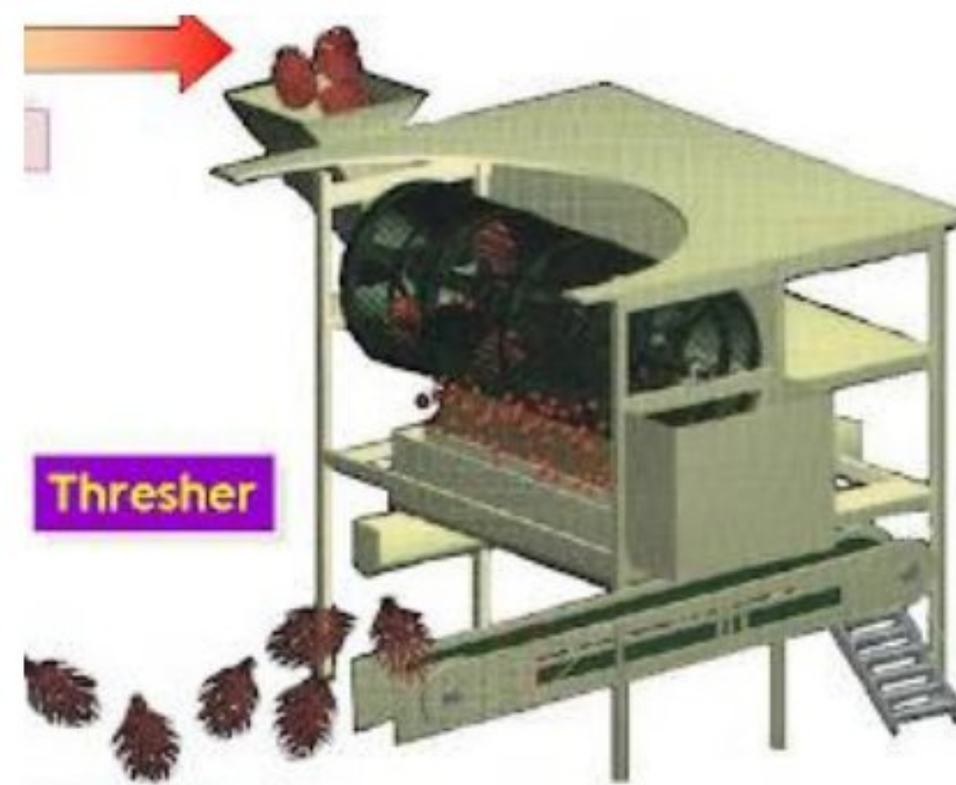
Gambar 4. Proses penebahan menggunakan mesin thresher (Lestari,2020)
