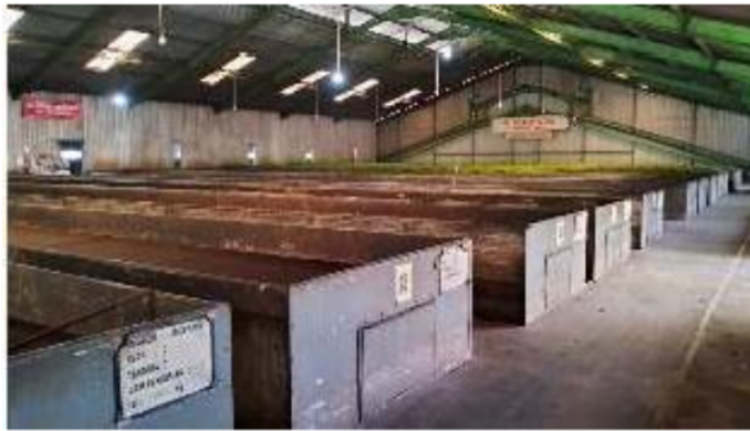
Gambar 2. Alat mesin pelayu teh ( withering trough ) (Sumber: Dokumentasi pribadi, 2023)
