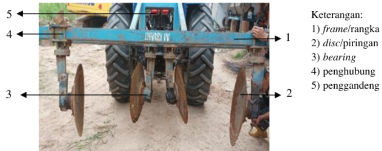
Gambar 3. Spesifikasi Implement disc cultivator (sumber: Dokumentasi pribadi, 2023)
