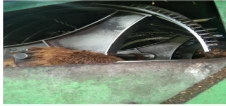
Gambar 11. Bagian drum *thresher* yang belum dibersihkan
