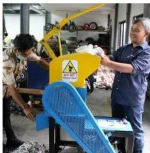
Gambar 13. Mesin pencacah plastik
