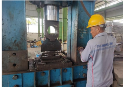
Gambar 11. Proses penekukan menggunakan mesin press
