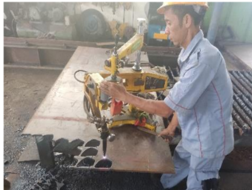
Gambar 6. Proses pemotongan plat menggunakan mesin cutting mekanis
