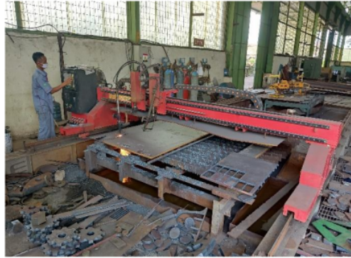
Gambar 5. Proses pemotongan plat menggunakan mesin CNC plasma/flame
