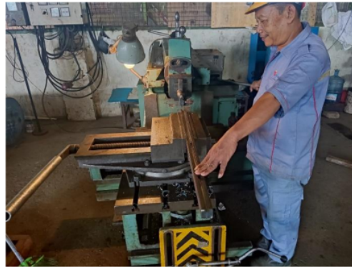
Gambar 10. Proses penyekrapan plat
