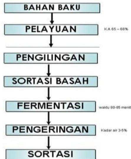
Gambar 1. Diagram alir pengolahan teh hitam *orthodox*
