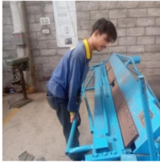
Gambar 15. Penekukan plat (Sumber: Dokumentasi pribadi, 2023)
