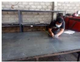
Gambar 12. Gambar pola dan pengukuran bahan baku (Sumber: Dokumentasi pribadi, 2023)
