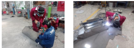
Gambar 16. Perakitan cover dan corong keluar (Sumber: Dokumentasi pribadi, 2023)
