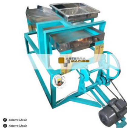
Gambar 2. Mesin sortasi gula semut (Sumber: https://www.asterra.id )
