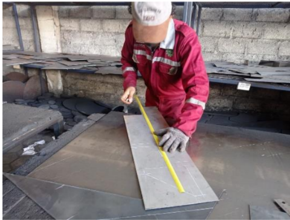
Pengukuran dan gambar pola plat stainless
