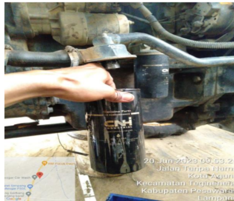
Gambar 14. Penggantian filter oli transmisi
