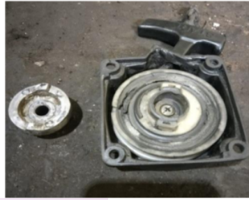
Gambar 15. Proses pergantian recoil starter (Sumber: Dokumentasi Pribadi, 2023)
