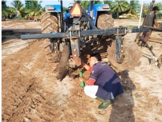
Gambar 7. Pelumasan Sumber: Dokumentasi pribadi, 2023
