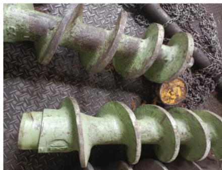
Gambar 7. Warm Screw (P, 31cm) Sumber: Dokumentasi Lapangan, 2023
