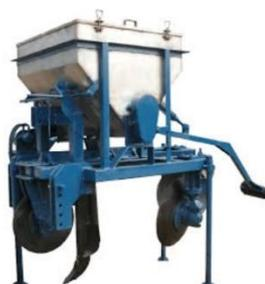
Gambar 1. *fertilizer aplicator ripper mounder*
