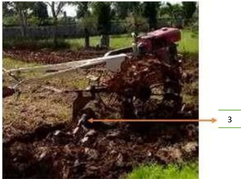
Gambar 6. Traktor tangan model quick zena dengan implement bajak singkal
