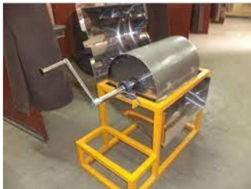
Gambar 5. Mesin Pencuci Bengkoang
