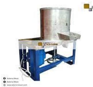
Gambar 4. Mesin pencuci ubi cilembu
