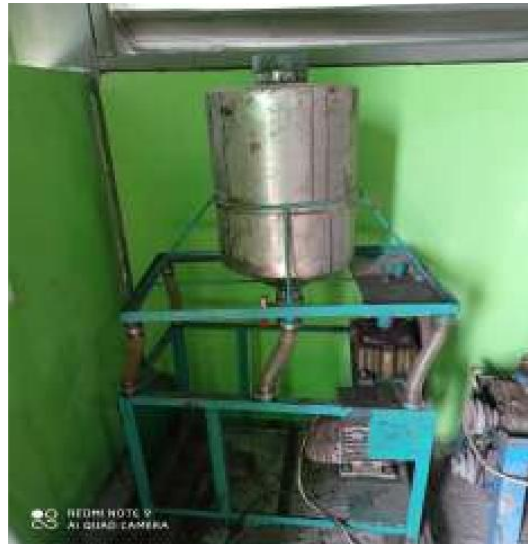
Gambar 3. Alat pendadiah vibrasi orbital.
