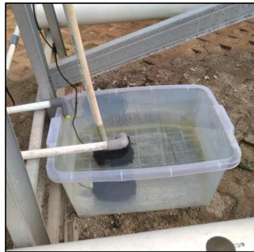
(b) Pompa dan Bak Nutrisi Hidroponik DFT
