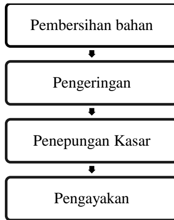
Gambar 1 Alur proses pembuatan tepung secara kering
