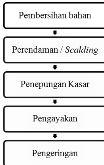
**Gambar 3.** Alur proses pembuatan tepung secara kering
