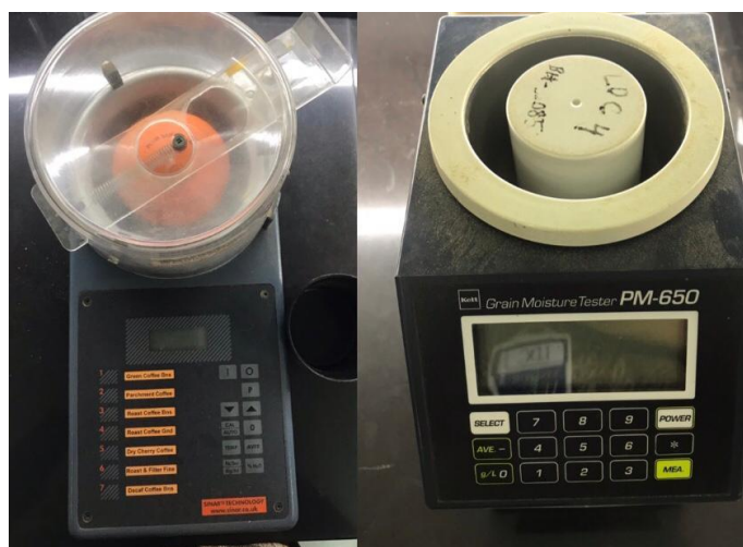
Gambar 2. Pengukur Kadar Air Sinar dan Kett Tester Sumber : PT LDC Coffee Indonesia 2021
