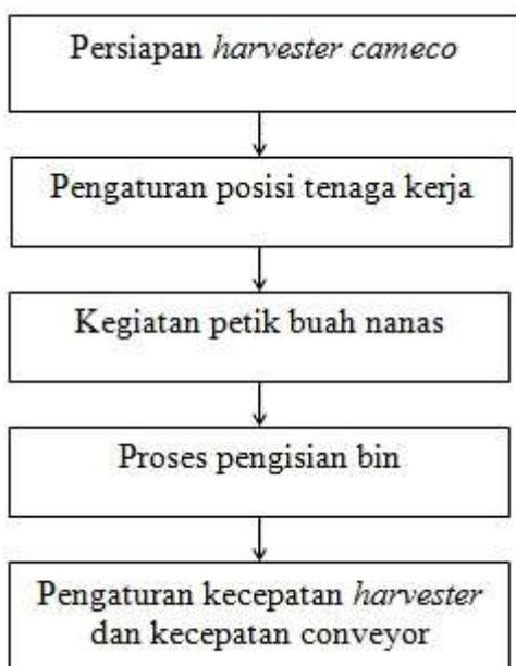
Gambar 5. Alur proses panen buah nanas secara mekanis
