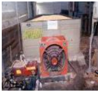
Gambar : 2.9 Pengeringan Gabah menggunakan flat bed dryer . Sumber : Yeni Eliza Maryana dan Dian Meithasari. Prosiding Seminar Nasional Agroinovasi Spesifik Lokasi Untuk Ketahanan Pangan Pada Era Masyarakat Ekonomi ASEAN
