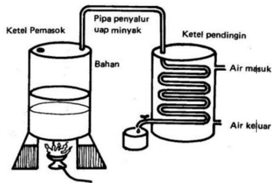
Gambar 5. Proses Penyulingan dengan Metode Air dan Uap
